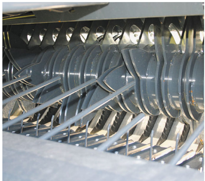
Bild 4: Die Pick-Up nimmt auch kleines Material sauber auf und ist von der Kabine aus gut einsehbar. Das Aufnahmevermögen von Pick-Up und Schneidrotor ist hoch.
