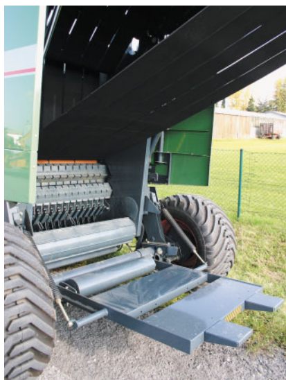
Bild 5: Der Ballen wird in der Presskammer durch 5 Endlosriemen und 3 Walzen (1 Stützwalze, 1 Motorwalze, 1 Starterwalze) geformt. Der fertige Ballen befindet sich zu etwa 2/3 in der Heckklappe, was das Auswerfen erleichtert. Ein Zurückrollen des Ballens wird durch die serienmäßige Ballenrampe verhindert.
