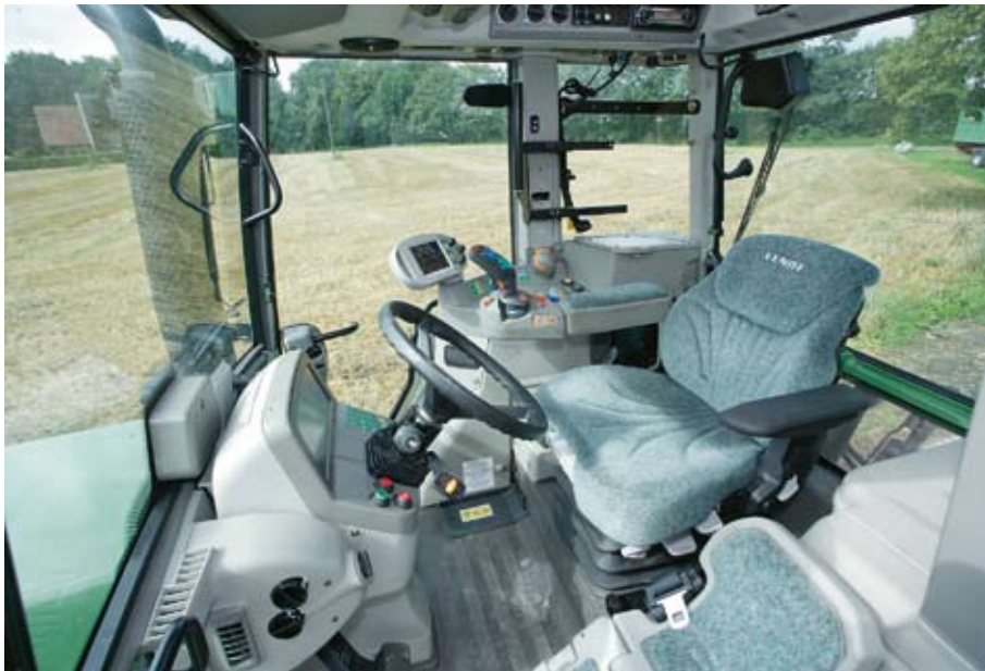
Zwar mit Klimaanlage, aber ohne Klima-Automatik: Die Kabine des Fendt 820 bietet nur durchschnittlichen Platz, war aber mit gemessenen 72,3 dB(A) recht leise.
